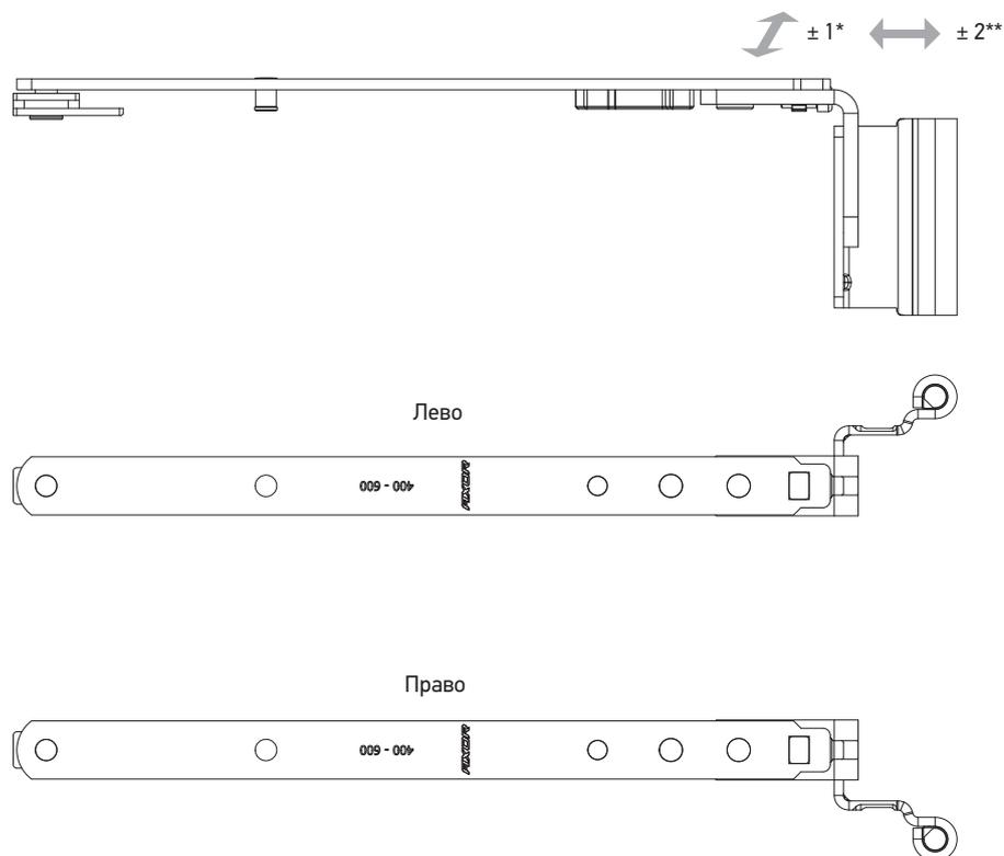
\* регулировка прижима, мм
