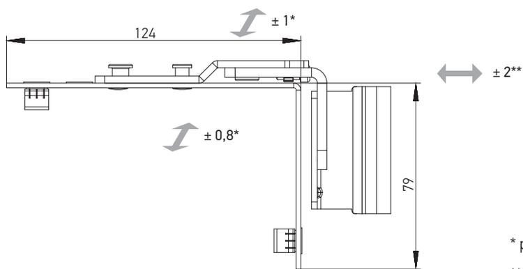
\* регулировка прижима, мм
