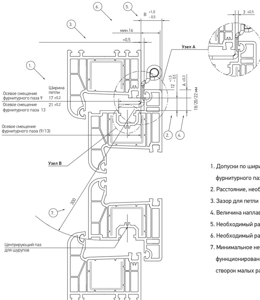
1. Допуски по ширине петли ножниц относительно оси фурнитурного паза
