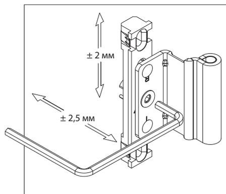
■ Опора микролифта-блокиратора
