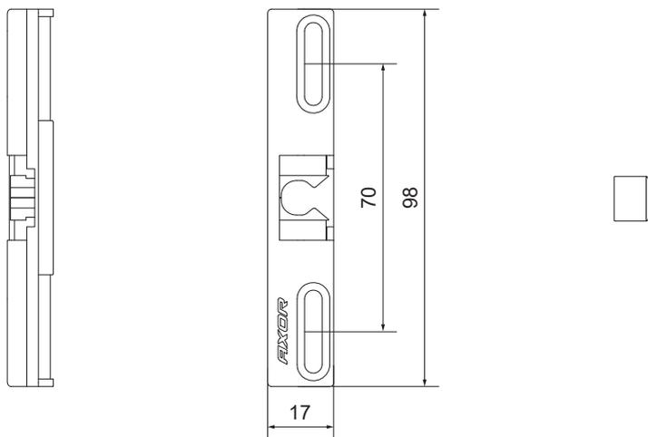
■ Балконная защелка для шульпового привода
