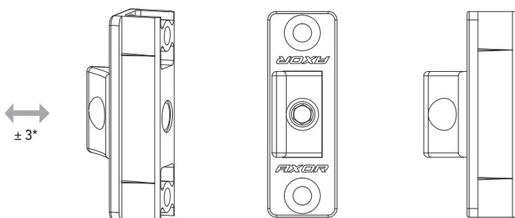
\* регулировка по горизонтали, мм
